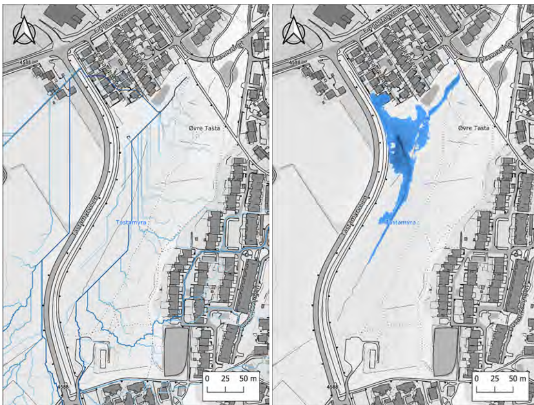
Figur 9. T.v. modell av hvordan vannet teoretisk flyter gjennom terrenget. Generelt kan vi si at Tastamyra heller fra øst mot vest, og fra sør mot nord. T.h. modell av en halv meter hevet vannstand. Dette tilsier at husene i nordvest vil kunne blir berørt av en hydrologisk endring i Tastamyra, for eksempel vannstandsheving. NB: Ingen av modellene tar høyde for avløpet.
