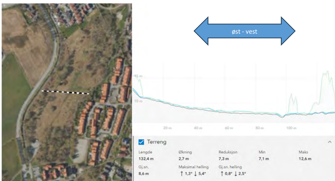
Figur 8. Figur viser terrenghøydeprofil gjennom Tastamyra fra øst mot vest. Svart linje viser terrenget, mens grønn linje viser overflatemodell (altså inkludert trær og busker).
