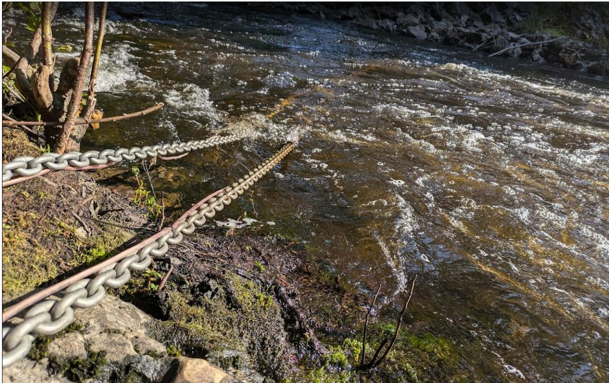
Figur 7. Det er valgt en løsning for permanent PIT-antenne, der denne er festet til kjetting som boltet fast på hver side av elva. Dette har vist seg å være eneste løsning som står imot sterk flom i elva, se forrige figur.
